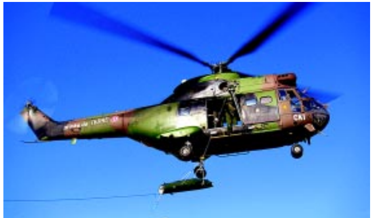
Puma descendant une civière (ATIC) lors d'un entraînement au Kosovo. La civière est maintenue du sol pour garder le contrôle de celle-ci en raison du souffle important de ces appareils. La civière ici représentée n'a pas encore reçu l'agrément (militaire) pour son utilisation avec une victime. - Photos Detalat Plana.
